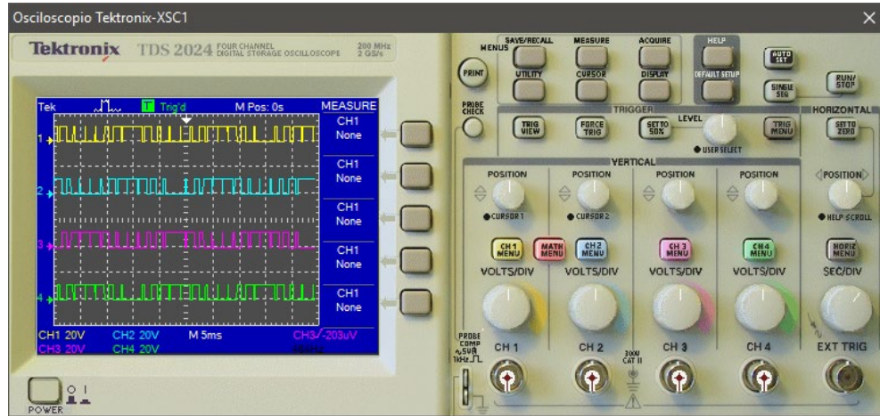
Figura 3.2: Patrón de pulsos para la etapa de potencia. (Fuente: Elaboración propia)
