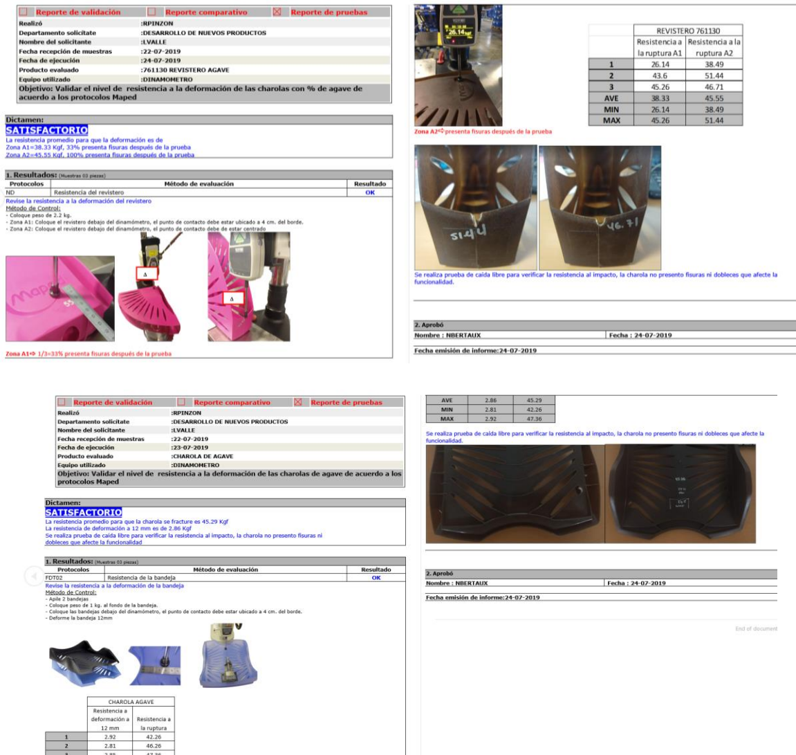
Figura 14. Resultados de la validación de propiedades mecánicas del revistero y charola portapapeles de acuerdo a protocolos de validación Maped Silco
