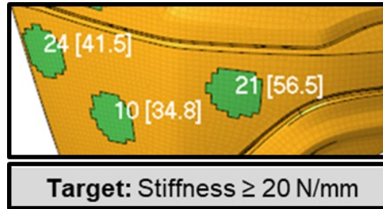
Figura 24. Análisis de rigidez a nivel ensamble final de una fascia. Muestra una imagen de referencia de las mediciones finales de rigidez del ensamble final de la fascia en la zona del bracket plástico Fuente: elaboración propia.
