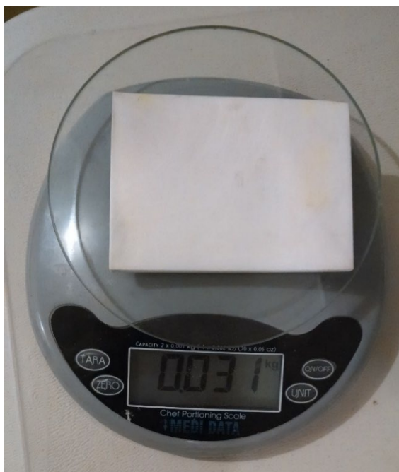
Figura 14 Peso de la probeta
