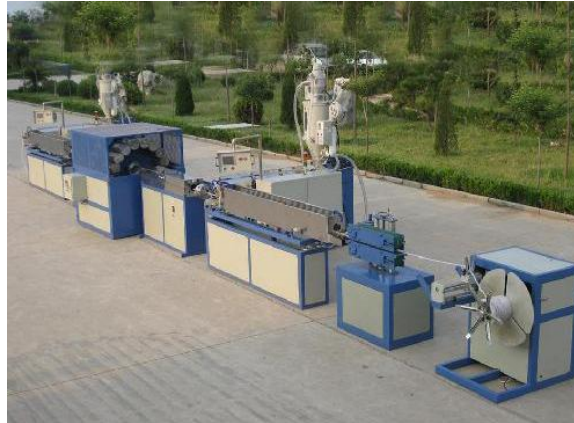
Figura 3 Extrusora para fabricación de manguera (Blanco Vargas, Diplomado en plásticos: módulo 4: aditivos y PVC, 2008)
