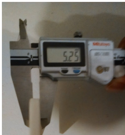
Figura 12 Espesor de la probeta
