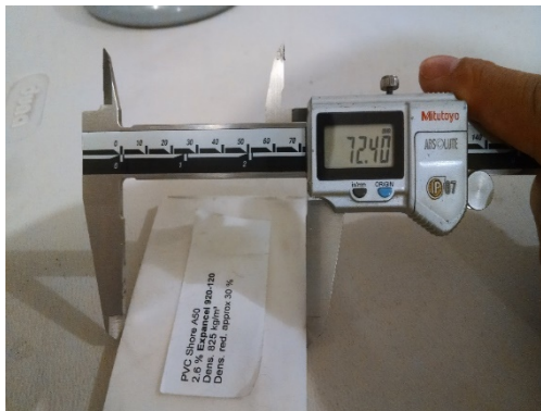
Figura 11 Ancho de la probeta
