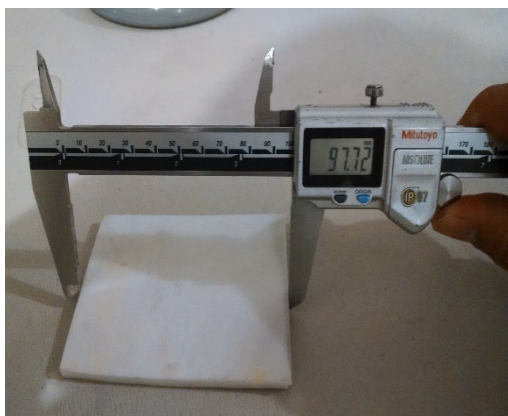
Figura 13 Largo de la probeta
