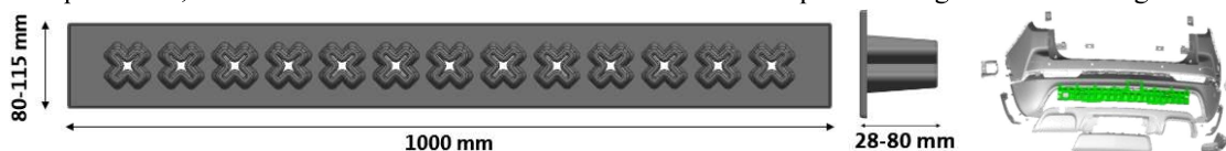
Figura 1. Diseño inicial para amortiguador de energía trasero en TPO. Se muestra la primera propuesta de diseño para un amortiguador de energía trasero para SUVs medianas.
