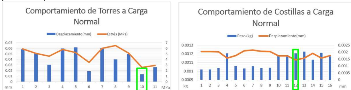
Fig.3. Comportamiento de costillas y torres a cargas normales. Muestran los resultados de la fuerza normal aplicada a probetas de costillas y torres de refuerzo.
