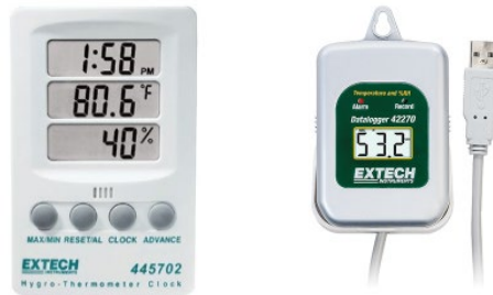
Figura 7. Ejemplos de instrumentos para monitorear condiciones ambientales (Flir Systems, 2019)
