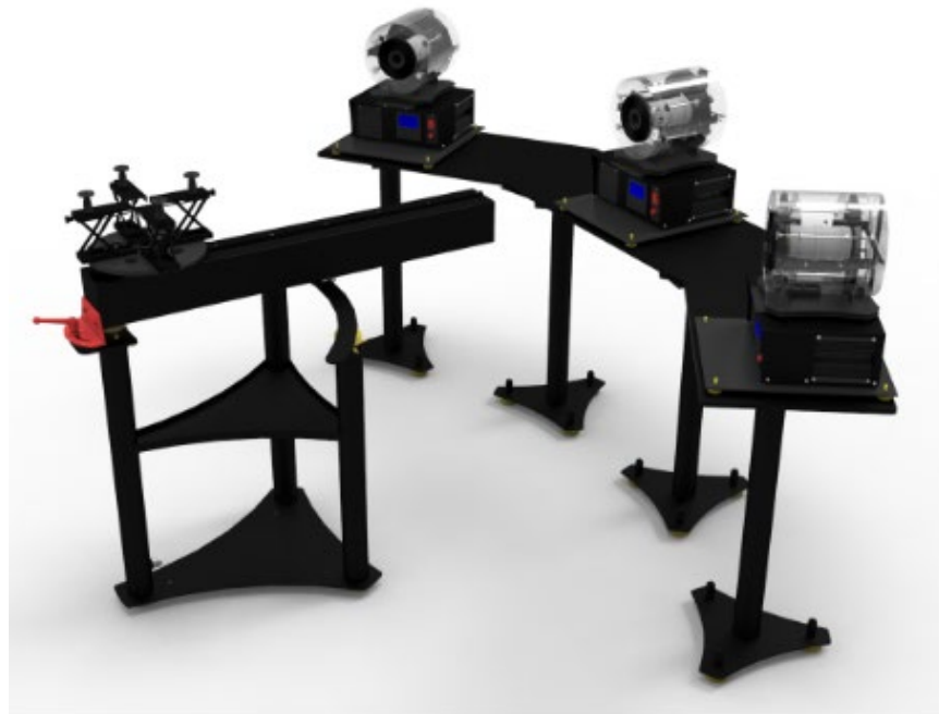
Figura 8. Arreglo experimental de un sistema de posicionamiento con desplazamiento longitudinal y radial, con tres fuentes de radiación. (Kapter, 2013)
