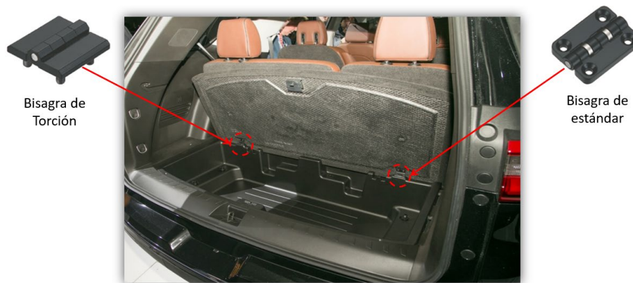
Figura 18 Cajuela de un SUV con los mecanismos comunes en el mercado actual Elaboración propia
