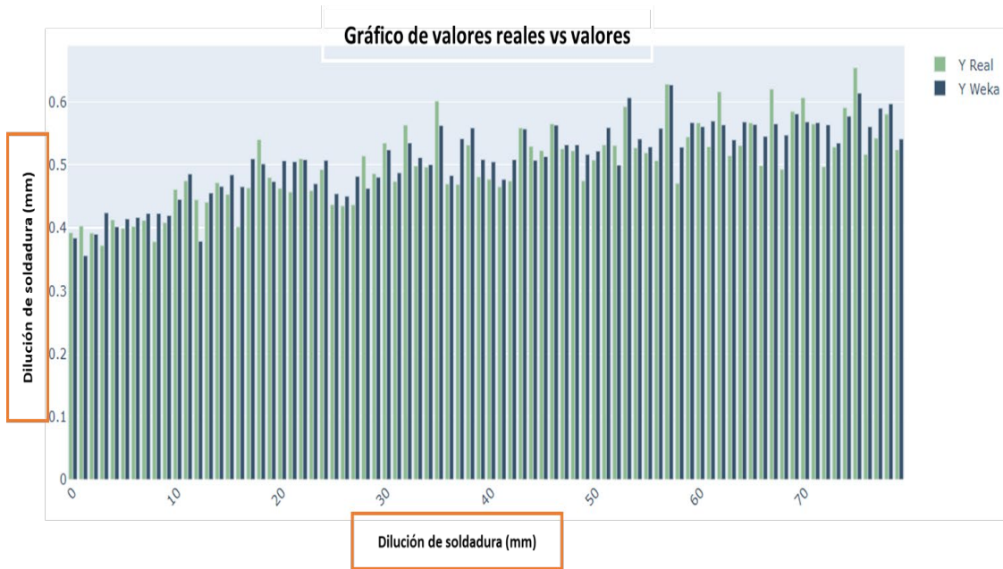
Figura 35. Gráfico de barras de los valores reales vs los valores predicho del modelo SMOreg para dilución de soldadura
