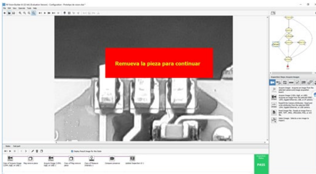
Figura 37. Secuencia de parte detectada como mala Elaboración propia
