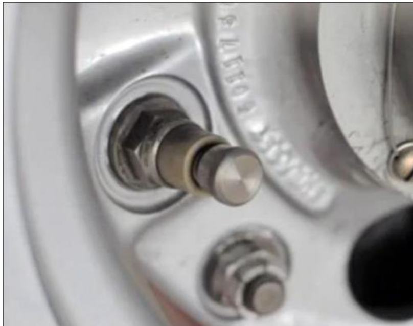
Figura 28. Sensor de presión de aire SmartStem RFID de la grúa reemplaza la válvula de llenado estándar.
