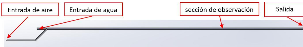
Figura 4. Modelo simplificado para simulación CFD.
