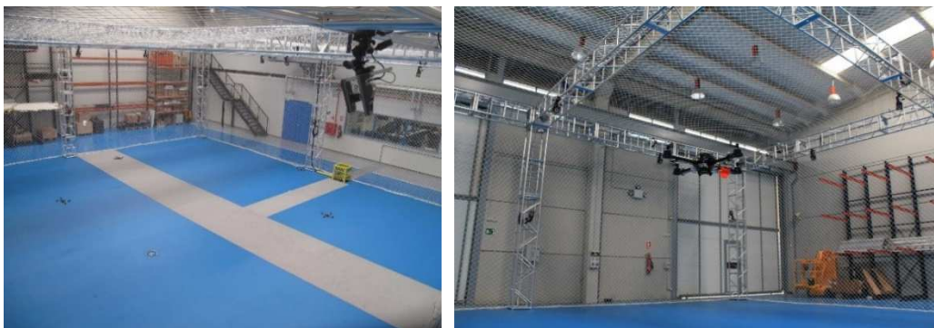
Figura 7 Banco de pruebas o Testbed en interiores [16].
