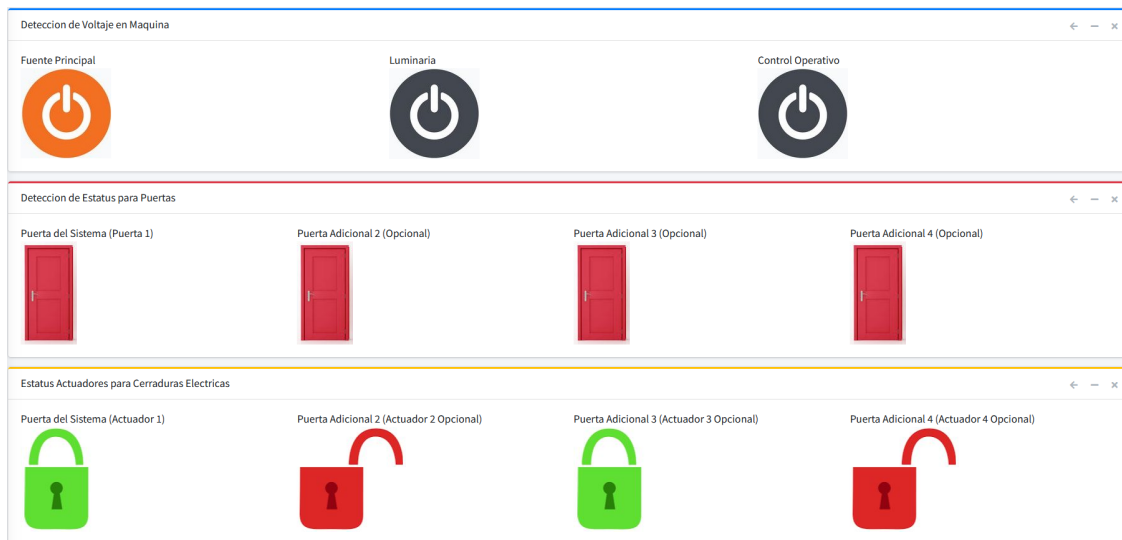
Figura 17. Estatus de los sensores de voltaje, puertas y actuadores Elaboración propia
