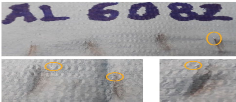
Figura 30. Filamentos detectados en pruebas con materia prima Al 6082 Elaboración propia
