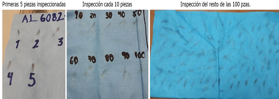
Figura 36. Sin partículas detectadas la prueba con material Al 6082 y proceso de alisado Elaboración propia
