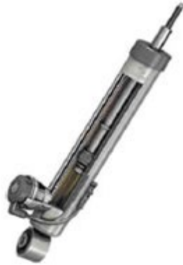
Figura 6. Amortiguador Semiactivo con válvula solenoide (Sachs) (ZF Friedrichshafen AG, 2020)
