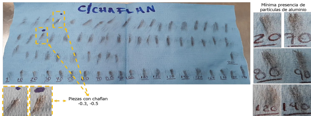
Figura 52. Partículas de aluminio detectadas en prueba con chaflán 1.0 mm x 60° Elaboración propia
