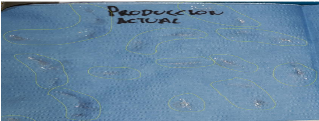
Figura 21. Partículas de aluminio en toalla de limpieza; condición inicial Elaboración propia
