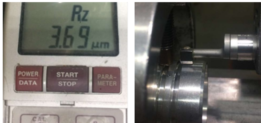
Figura 58. Medición de rugosidad R_z en zona de cierre Elaboración propia
