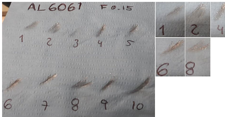
Figura 42. Partículas detectadas en prueba con f=0.15 mm y chaflán de -0.3, -0.5 mm Elaboración propia
