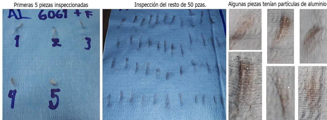
Figura 38. Partículas detectadas en prueba con material Al 6061 y proceso de alisado Elaboración propia
