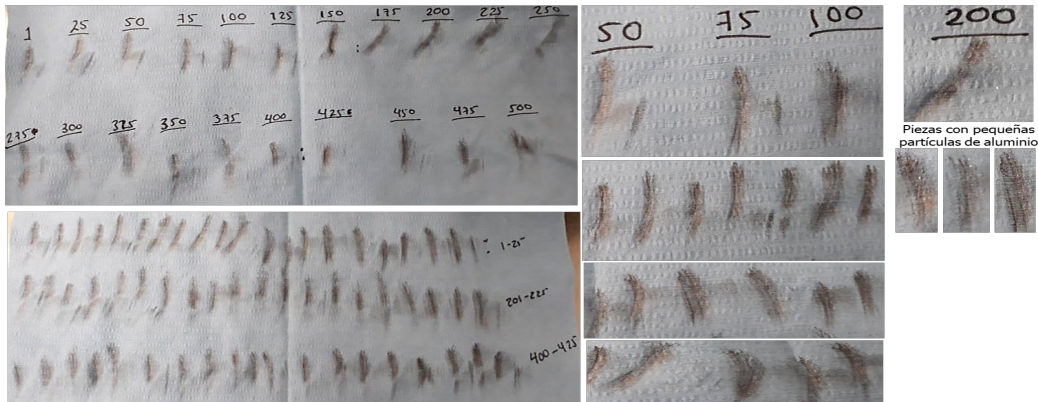
Figura 65. Partículas de aluminio detectadas en prueba con recubrimiento C Elaboración propia
