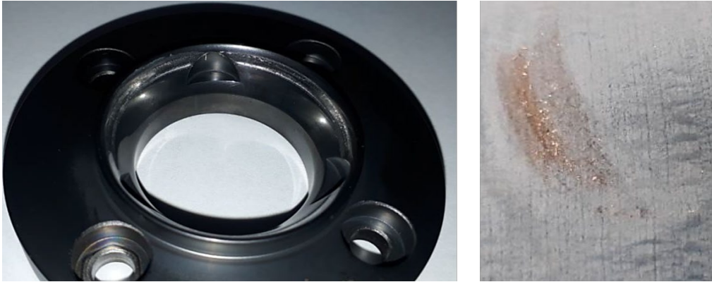
Figura 64. Herramental con recubrimiento B después de la prueba Elaboración propia
