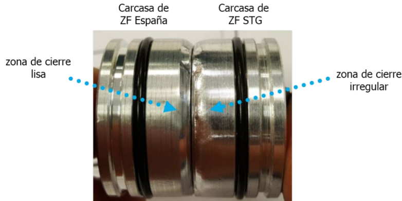
Figura 27. Comparativo de zona de cierre, prueba en ZF España Elaboración propia
