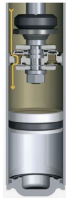
Figura 11. Principio de tracción del amortiguador Monotubo (ZF Friedrichshafen AG, 2021)
