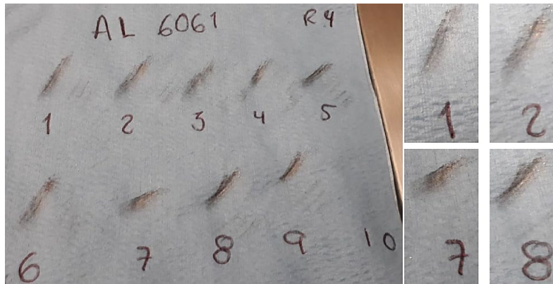
Figura 46. Partículas detectadas en prueba con f=0.20 mm y radio de 0.4 mm Elaboración propia
