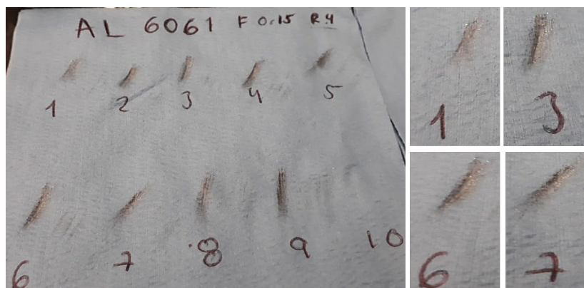
Figura 44. Partículas detectadas en prueba con f=0.15 mm y radio de 0.4 mm Elaboración propia
