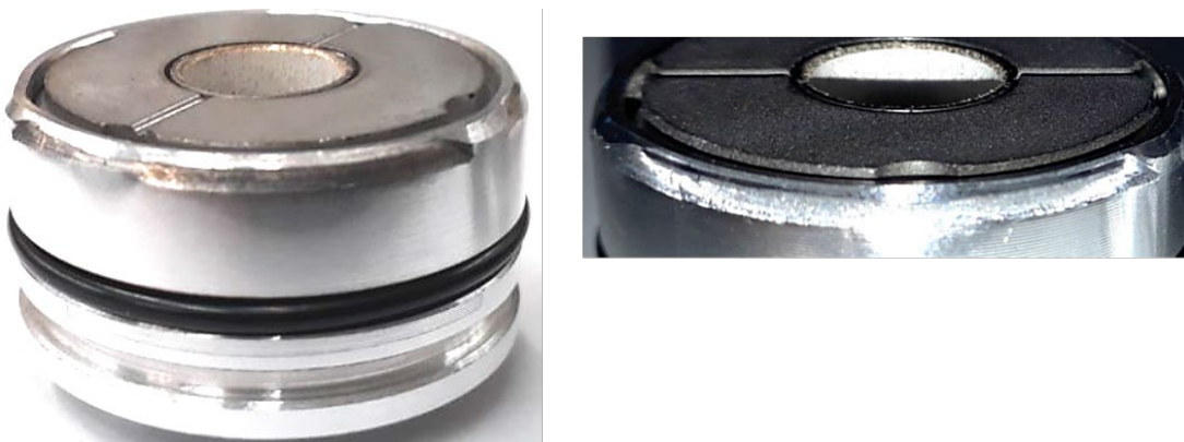
Figura 63. Zona de cierre irregular en pruebas con recubrimiento B Elaboración propia
