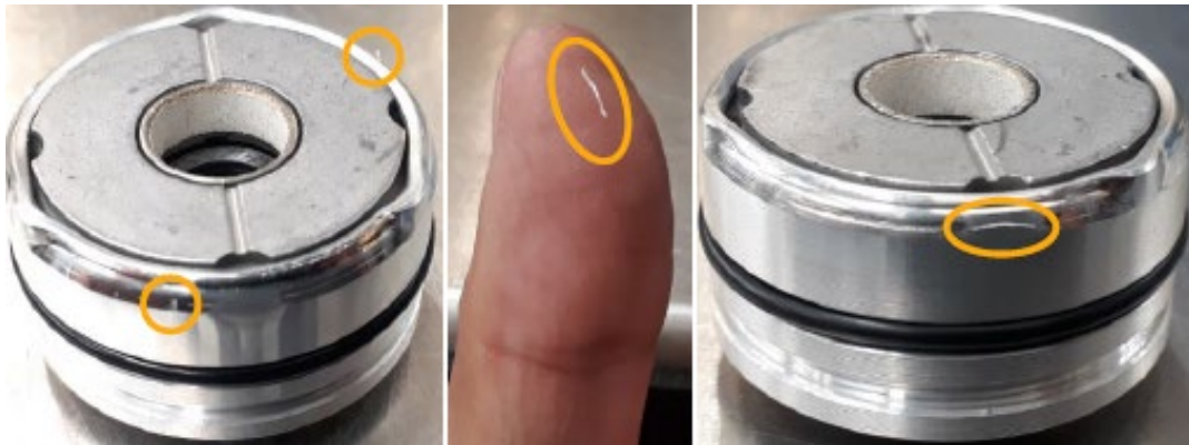
Figura 32. Filamentos detectados en segunda prueba con materia prima Al 6082 Elaboración propia
