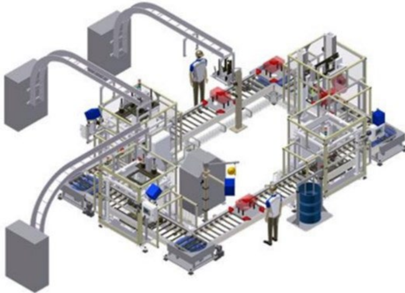
Figura 3. Ejemplo de línea de ensamble semiautomatizada. (Induma, s. f.)
