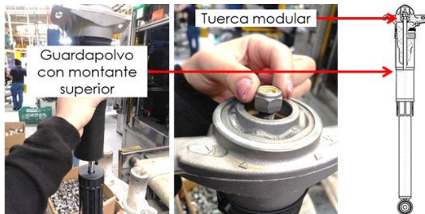
Figura 26. Ensamble manual de componentes modulares Elaboración propia
