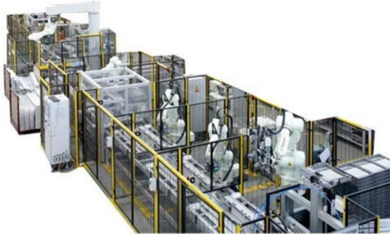
Figura 4. Ejemplo de línea de ensamble automatizada (DirectIndustry, s. f.)
