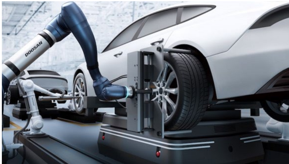
Figura 9. Atornillador montado a robot colaborativo
