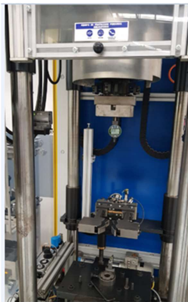
Figura 17. Medición en campo de la posición del porta herramental. Elaboración propia.
