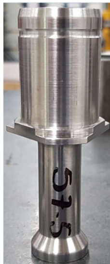
Figura 20. Pieza de presión utilizada para primer estudio de evaluación de control por fuerza y distancia. Elaboración propia.
