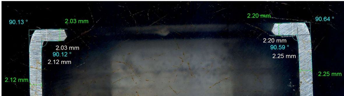
Figura 25. Doblez de lámina después de sellar. Elaboración propia.
