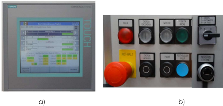
Figura 29. Panel de control. a) Interfase grafica HMI. b) Botones de mando. Elaboración propia.
