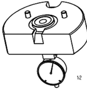
Figura 16. Dispositivo de medición de posición de porta herramental. Elaboración propia.
