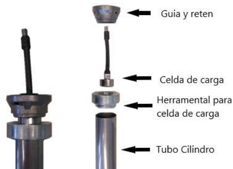
Figura 10. Ensamble de un amortiguador con celda de carga para medición de fuerza residual. Elaboración propia.
