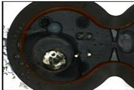
Figura 28: Fotografía de burbuja observada en prueba de fuga.
