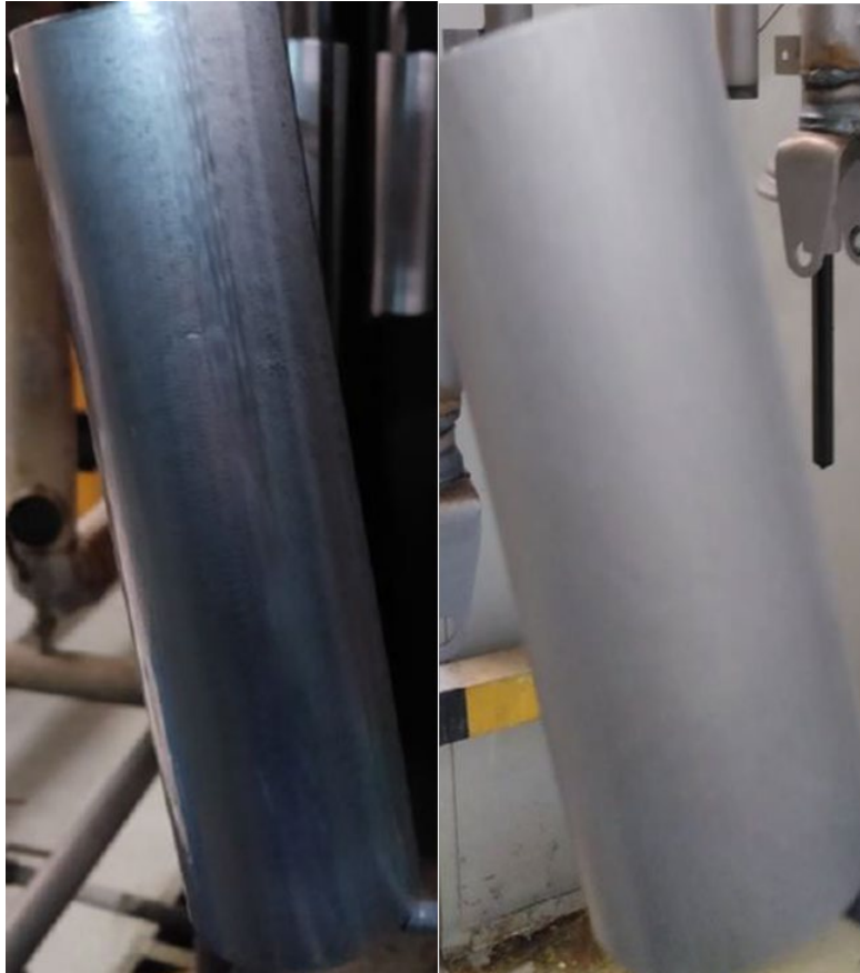
Figura 34 (Izquierda) Imagen de un tubo antes de proceso de pretratamiento, se observa brillante y residuos de proceso anteriores. (derecha) Se observa tubo sin brillo y gris opaco. Elaboración propia
