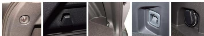
Figura 1. Puntos de sujeción para la red de carga.
