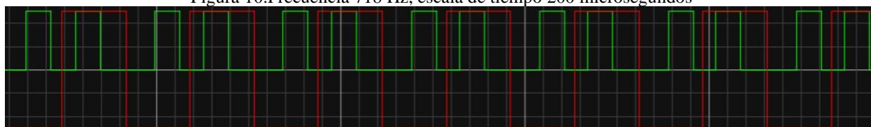
Figura 10. Frecuencia 718 Hz, escala de tiempo 200 microsegundos
