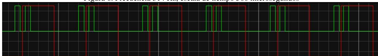
Figura 7. Frecuencia 415 Hz, escala de tiempo 500 microsegundos
