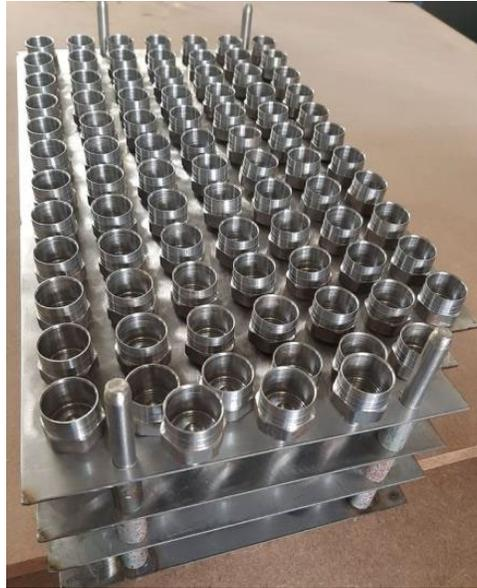
Figura 25. Acomodo de especímenes en el horno.
