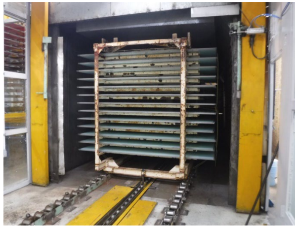
Figura 41. Lote de material entrando al horno de post-curado. Elaboración propia.
