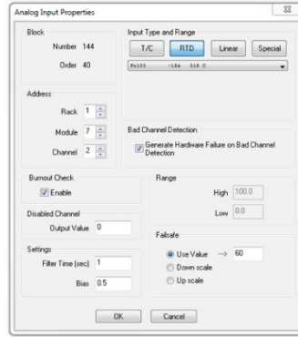
Figura 53. Configuración del bloque de función para entrada analógica. Elaboración propia.
