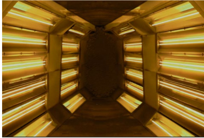
Figura 10. Interior de un horno de radiación. (POWDERTRONIC, 2022).
