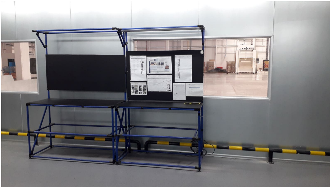
Figura 37. Mesas de inspección de partes con su documentación, HOE, Ayudas visuales y normas de empaque. Elaboración propia.
