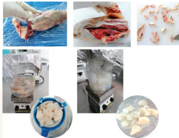
Figura 1. Proceso de extracción de colágeno a partir de residuos de búfalo.
