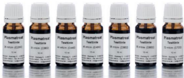
Figura 6. Maletín de tintas de medición de tensión superficial [31].
