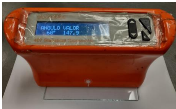
Figura 9. Medición de brillo en placa de vidrio.
