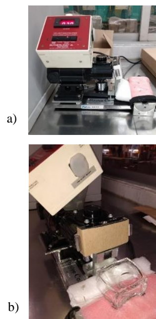
Figura 4. Aplicación de Rub tester. a) Vista Frontal b) vista lateral aplicando el contacto con el cartón.
