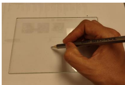
Figura 10. Medición dureza bajo norma ASTM D3363.
