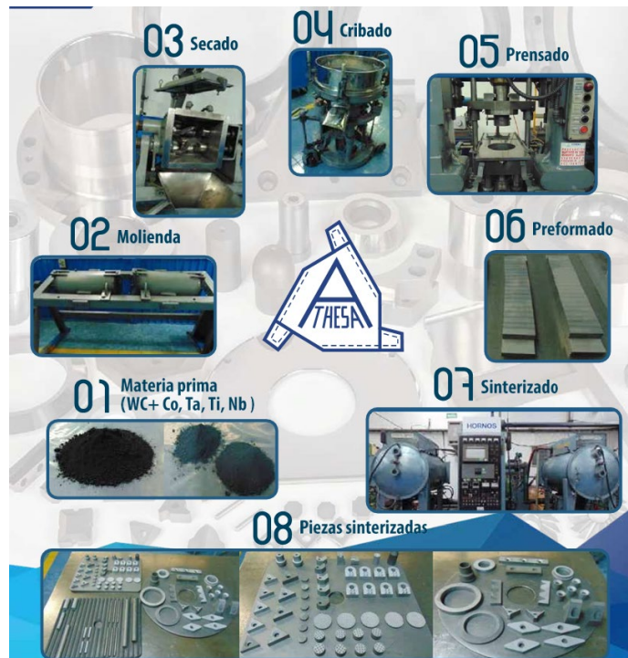
Figura 5. Proceso de metalurgia de polvos en ATHESA (Athesa, 2022)
