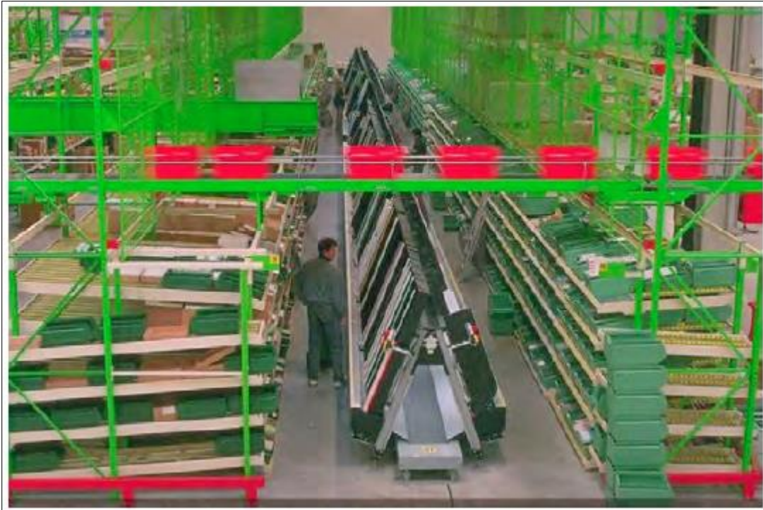
Figura 12. Un dispensador A-Frame automático, visto desde arriba del conveyor. Los racks de flujo están ubicados a ambos lados del A-Frame y son reabastecidos a granel.
