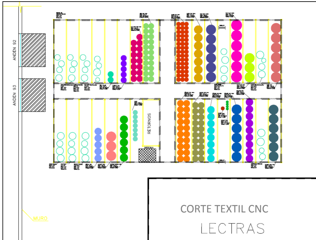
Figura 9. Nueva distribución del almacén con su designación para cada carril de almacenamiento y el nuevo orden de los rollos.
