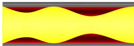
Figura 12. Flujo anular (annular Flow) (Basu, 2018, pág. 817)
