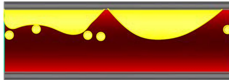
Figura 10. Flujo tipo bache (slug Flow) (Basu, 2018, pág. 817)
