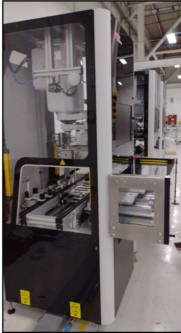
Figura 49. Celda de manufactura de colocación de tapas Elaboración propia
