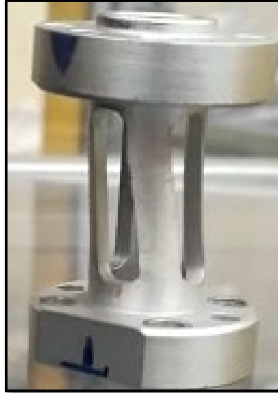
Figura 45. Cople mecánico deformado debido a una colisión (Ramos Arreguín, Salazar Colores, Cabal Yopez, & Vargas Soto, 2022)
