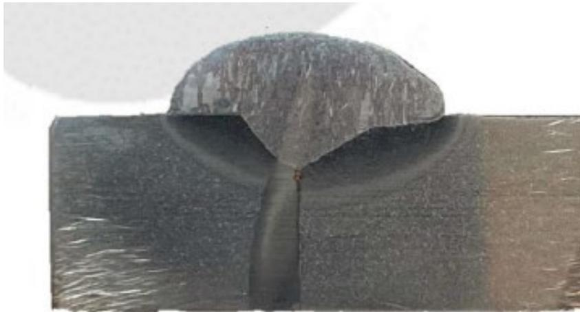
Figura 29. Resultado pieza pulida y ataque químico.
