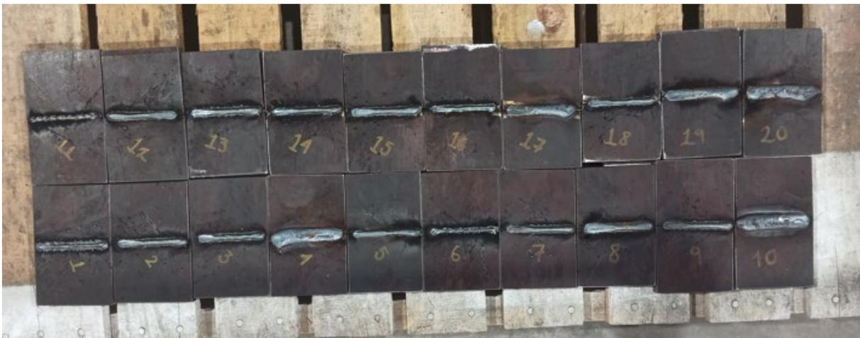
Figura 26. Piezas con soldadura aplicada según parámetros y marcadas con el orden establecido.
