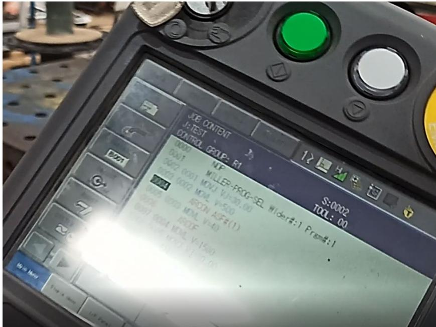
Figura 13. La selección de los parámetros se realiza en la asignación mediante la línea 0001 – MILLER-PROG-SEL Wlder#:1 Prgm#1. Se indica que tomará la combinación #1 ingresada en el ARC START CONDITION.
