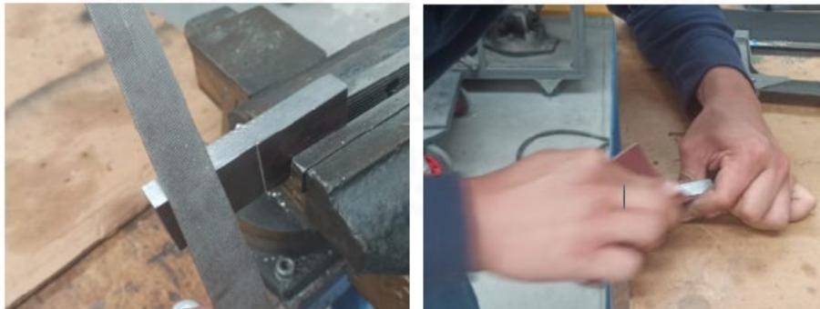
Figura 16. Preparación de la superficie de la cara donde se realizará la medición de la penetración.
