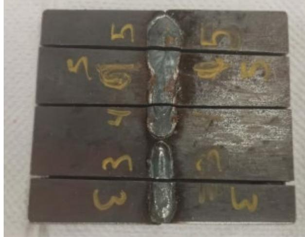
Figura 15. Pieza seccionada en los puntos donde se revisará la penetración de la soldadura.
