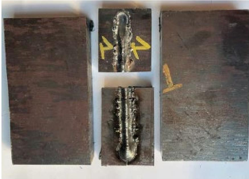
Figura 28. Forma del corte de las probetas.
