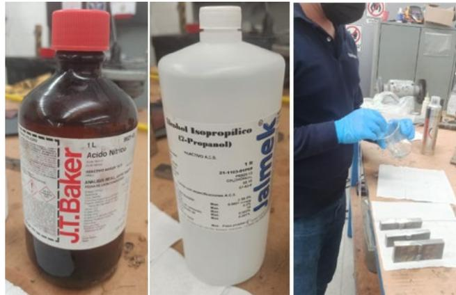
Figura 17. Preparación de la mezcla para el ataque químico en la superficie de la pieza, para la prueba rápida de penetración.
