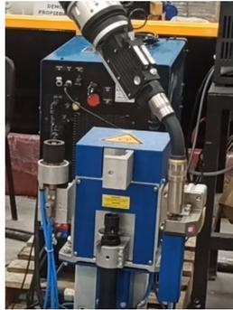
Figura 10. Equipo de corte de alambre a la posición determinada al terminar la soldadura del cordón. Se asegura la distancia del alambre en la tobera de la antorcha.
