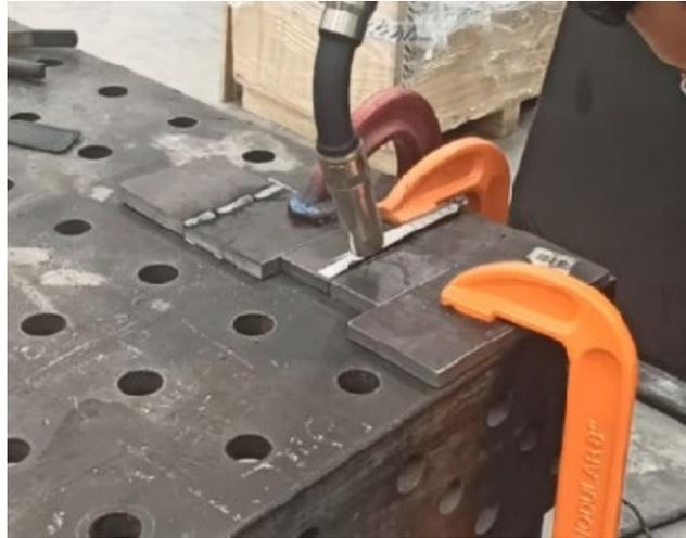
Figura 14. Sistema de registro para la fijación de las piezas.
