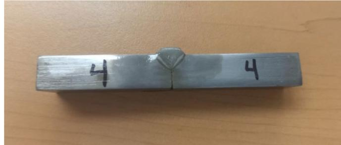
Figura 19. Pieza con aplicación de laca transparente en cara de pieza con penetración revelada.
