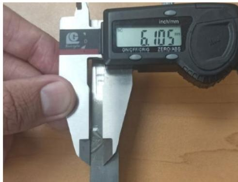
Figura 20. Medición de la distancia de penetración.
