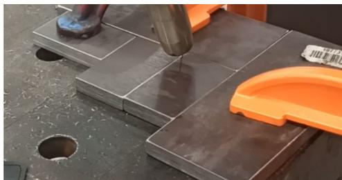
Figura 9. Preparación de la posición de las piezas (unión a tope) para las pruebas preliminares.
