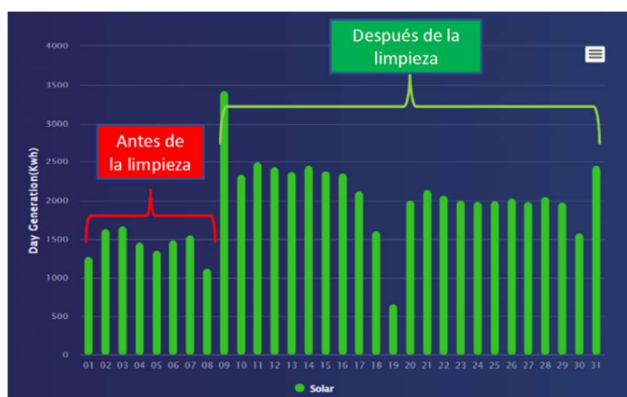
Fig. 18. Gráfica mensual de monitoreo del sistema fotovoltaico.
