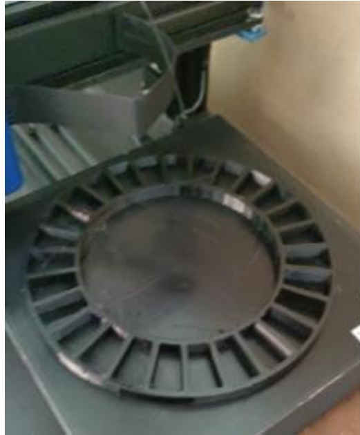
Figura 8. Resultado final del inserto de empaque impreso en 3D Elaboración propia
