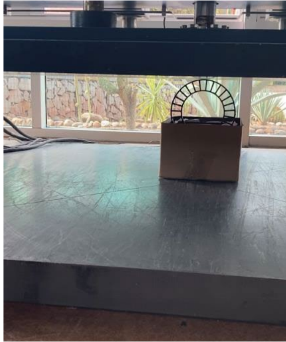
Figura 9. Inserto de prueba en máquina de compresión del laboratorio Elaboración propia
