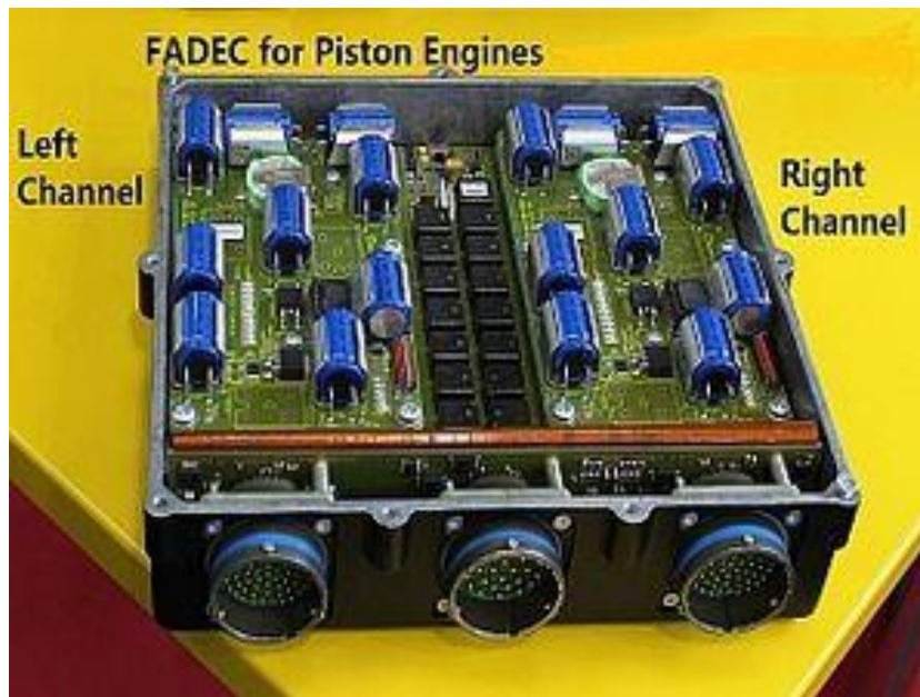
Ilustración 3 Canales del FADEC
