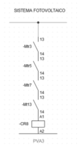
Figura 63. Control de arranque del sistema fotovoltaico. Elaboración propia
