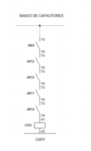
Figura 61. Control de arranque del banco de capacitores. Elaboración propia
