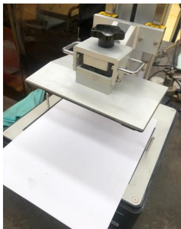
Fig. 7. Calibración del equipo en eje z.
