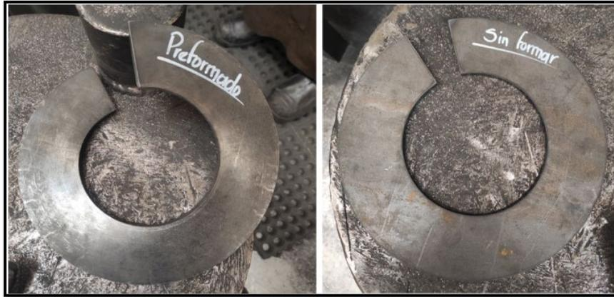
Figura 34. Perfiles cortados en acero A36 para pruebas experimentales (lado izquierdo con la pieza preformada, lado derecho la pieza sin preformar).
