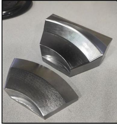
Figura 32. Herramientales prototipos manufacturados en acero 4140 con endurecimiento superficial.
