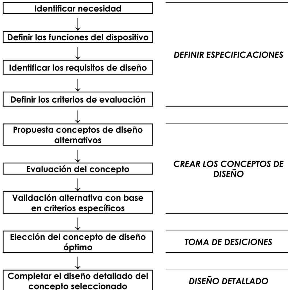
Figura 13. Pasos para el proceso de diseño mecánico.
