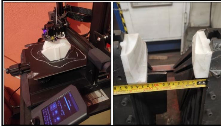
Figura 16 . Proceso de impresión 3D de herramientas prototipo y montaje en prensa horizontal.
