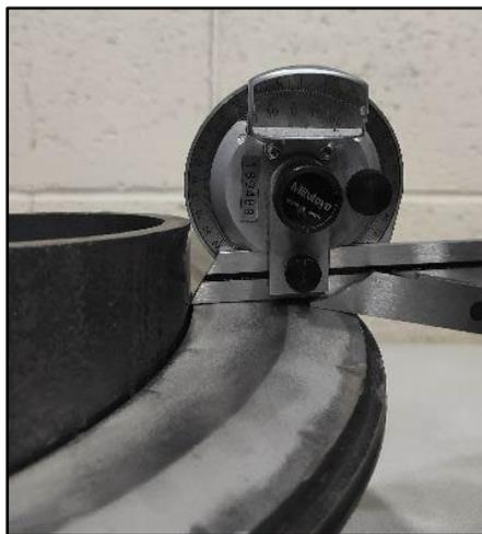
Figura 38. Medición del ángulo una vez hecho el ensamble, de doblez en la parte posterior del alabe.
