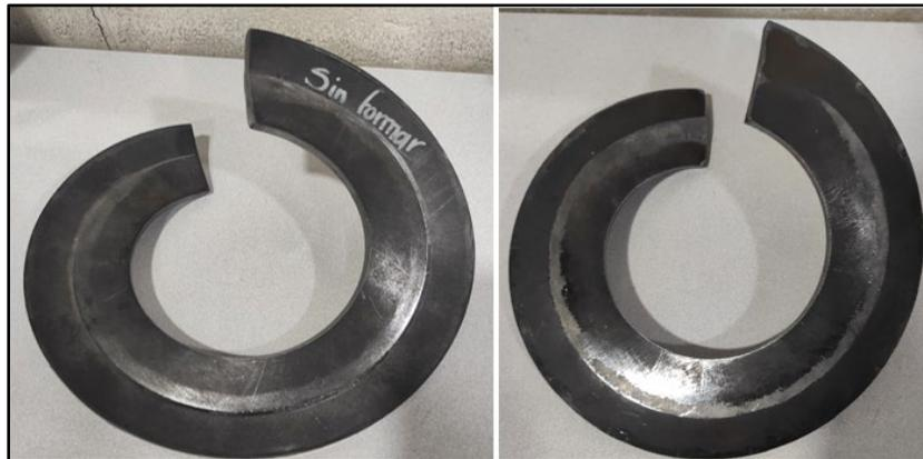
Figura 36. Prueba experimental para la pieza sin preformar del perfil cortado en placa de acero A36.
