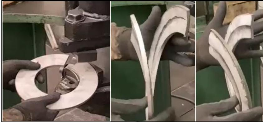
Figura 37. Prueba experimental para la pieza sin preformar del perfil cortado en placa de acero A36.
