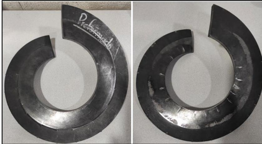
Figura 35. Pieza preformada y conformada de placa de acero A36.
