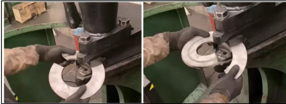
Figura 18. Conformado por secciones de un perfil helicoidal cóncavo en placa de acero inoxidable 304 de  $\frac{1}{4}$ " de espesor.
