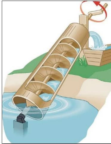
Figura 1. Esquema del transportador helicoidal inventado por Arquímedes.
