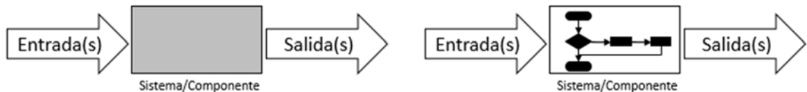
Figura 6 Pruebas de caja negra (izquierda), Pruebas de caja blanca (derecha)
