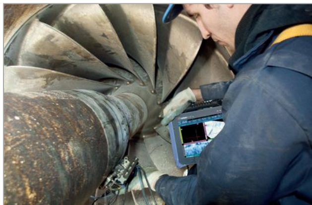
Figura 9. OmniScan SX en inspección de soldadura por arreglo de fases. Fuente: Catálogo del OmniScan SX – Olympus.
