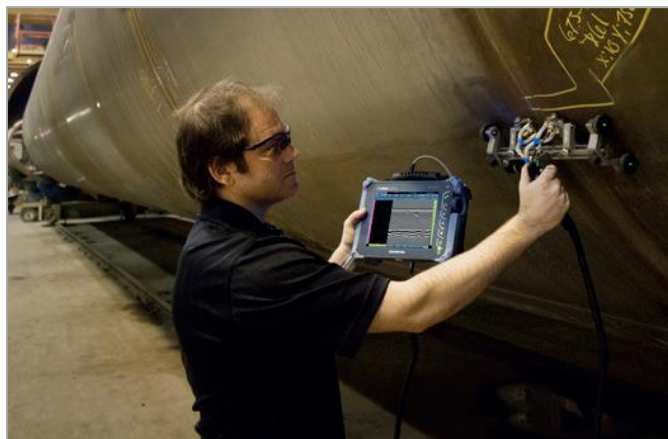
Figura 11. OmniScan SX en la inspección de soldaduras con la técnica TOFD.
