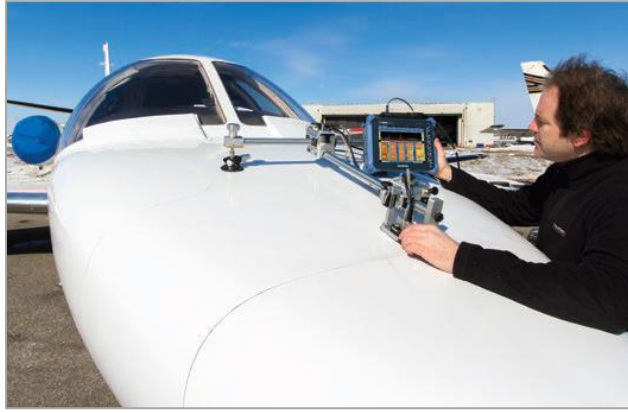
Figura 10. OmniScan SX en el mapeo de corrosión e inspección de materiales compuestos.
